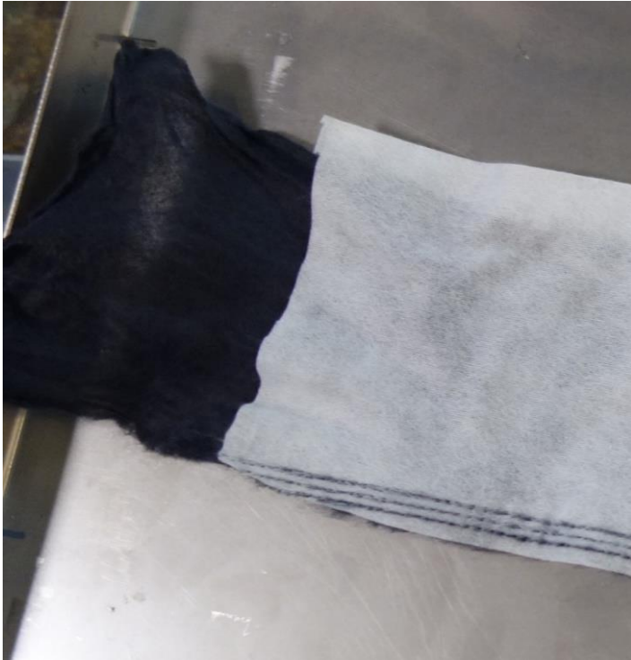
Abbildung 2; Filznaht in schwarzem und weißem Vlies
